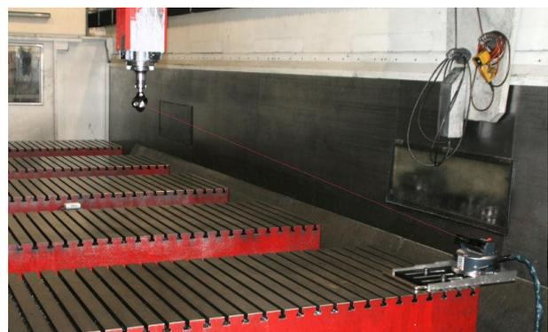
DAS INTERFEROMETER DES LASERTRACERS FOLGT VOLLAUTOMATISCH DEM IN DER SPINDEL EINGESpanNTEN REFLEKTOR DURCH DEN GANZEN ARBEITSRAUM. DABEI WERDEN HOCHGENAUE MESSUNGEN DURCHFÜHRT, AUS DENEN DIE AchSABWEICHUNGEN GERECHNET WERDEN.
