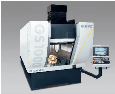
Mittels Finite-Elemente- und Modalanalyse optimiertes Bearbeitungszentrum GS 1000/5-FDT mit extremer dynamischer und statischer Steifigkeit und höchster Präzision durch thermosymmetrischen Aufbau des Box-in-Box-Systems
