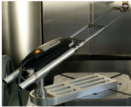
Der LaserTracer-MT wurde von Etalon für die Kalibrierung und Überwachung von Werkzeugmaschinen entwickelt. Grundkomponente ist ein Laserinterferometer mit Nanometer-Auflösung, das vollautomatisch einem Reflektor folgt und so in fast jede beliebige Richtung Längenmessungen mit höchster Genauigkeit durchführen kann.
