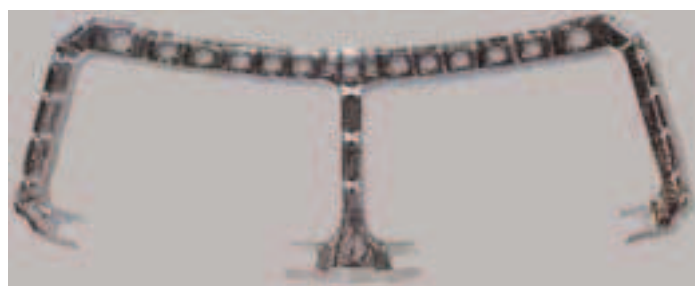
Typische Strukturteile aus dem Flugzeugbau haben innen konisch zulaufende Flanken mit drei bis fünf Grad Anstellwinkel. Diese Taschen können bei Kegelmann Technik mit dem M3 ABC mit idealer Vorschubgeschwindigkeit gefräst werden Bilder: EADS
